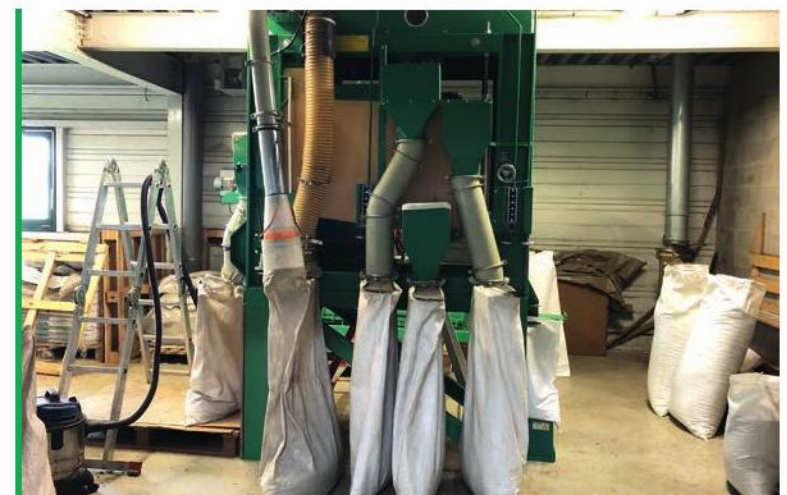
La trieuse sépare les graines de silène des débris végétaux. Les fleurs blanches d'origine sauvage et locales ont été moissonnées par un agriculteur qui les a cultivées pour Nungesser Semences. Le mulch passe par différents tamis. © Anne Frintz
